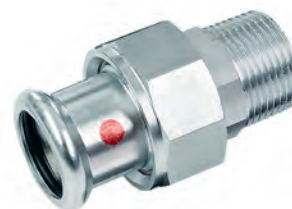
3-delige koppeling met vlakke dichting conische buitendraad (R) x press (m-profiel)
